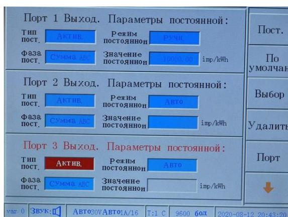
Рисунок 4.7.1 Подрежим установки постоянных для выходных импульсных каналов
