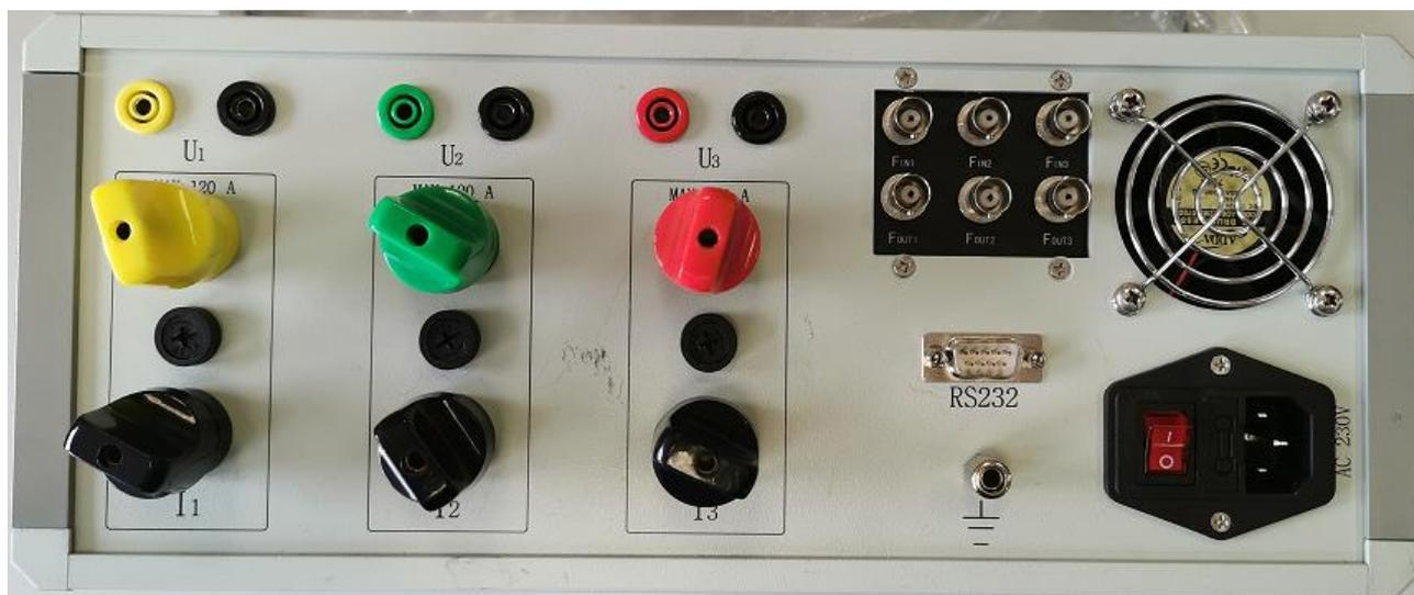
Рисунок 2.6.2 - Задняя панель Прибора НЕВА-Тест 5320
