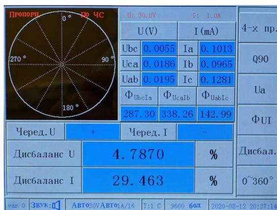
Рисунок 4.5.4 Интерфейс режима измерения угловых параметров " $\Phi_{UI}$ " с функцией "Unbalan" при трехфазном четырехпроводном подключении
